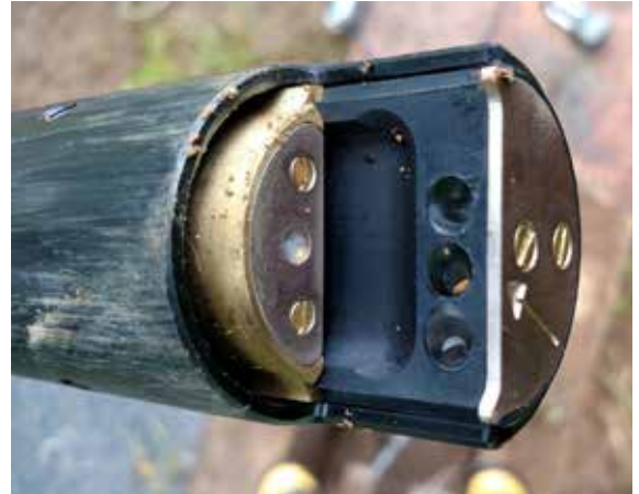
Figura 3B. OBS501 con obturador abierto durante visita de mantenimiento
