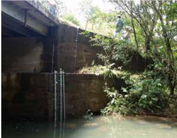
Figura 3A. Conducto para los sensores de turbidez, conductividad y temperatura, además del tubo de muestra
