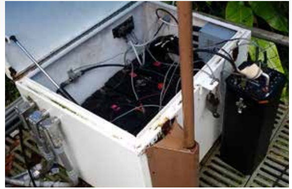
Figura 2B. Recinto de datalogger personalizado de Campbell Scientific diseñado para cumplir con las especificaciones de WET
